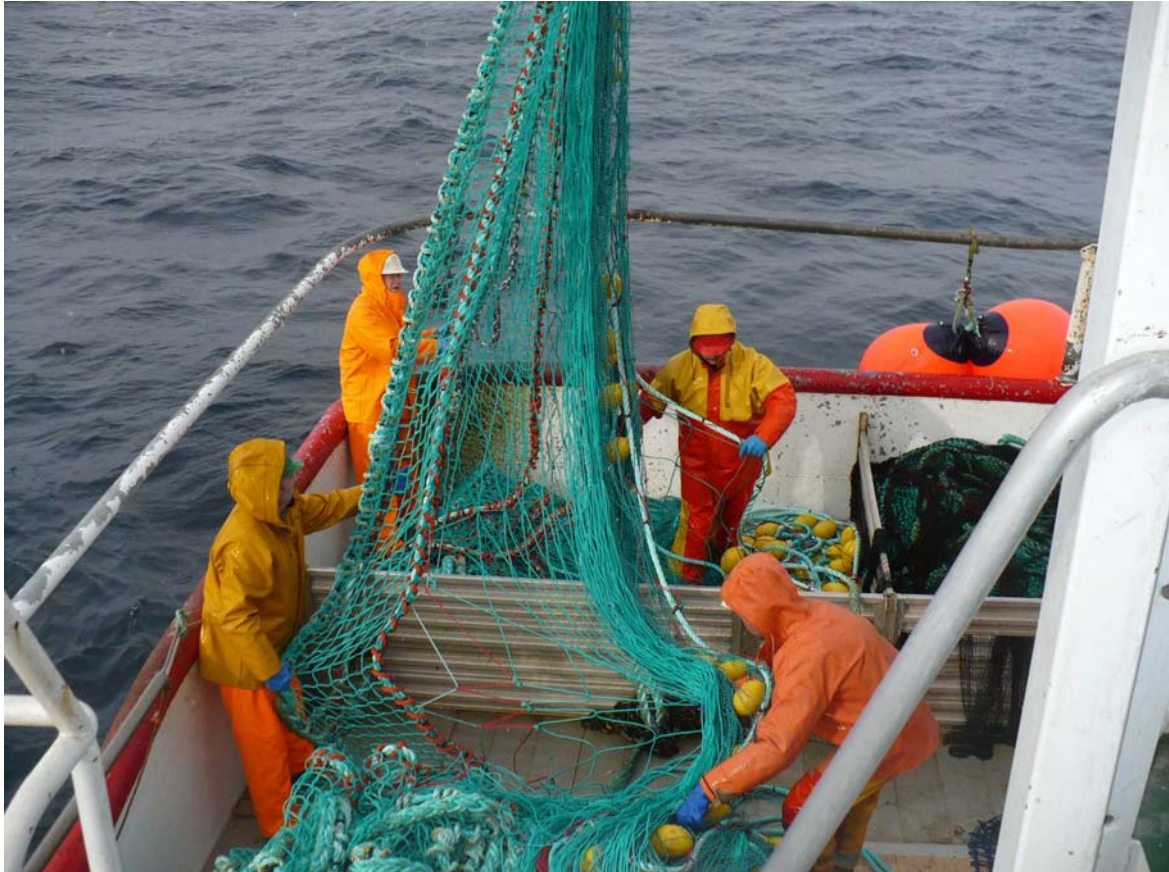
Bilde 16 Inntak og legging av snurrevadnot på hekken (akterut)
