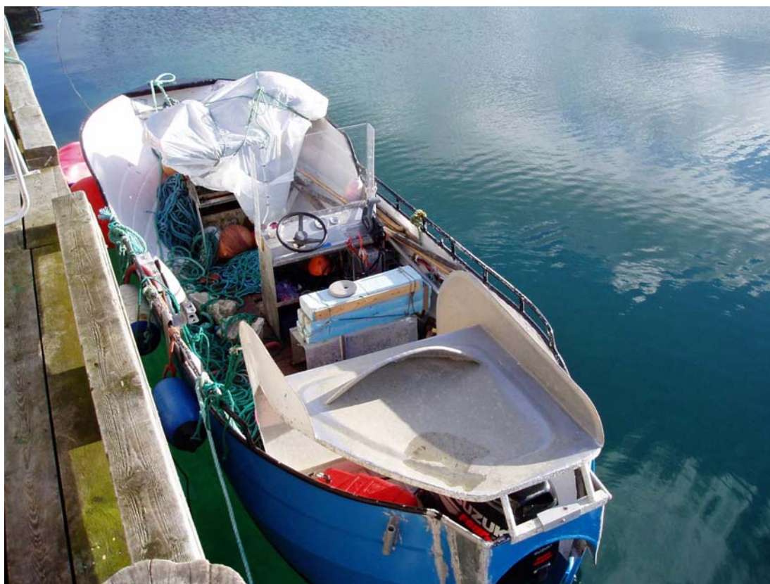
Bilde 3 Fjordfiskebåt på 17 fot lengde i aluminium, rigget for garnfiske
