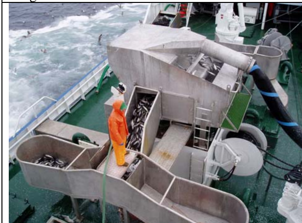
Sildefangsten pumpes om bord i RSW-tanker
