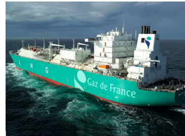
Gaz de France energy DF-electric LNG Carrier Gaz de France Alstom Chantiers de l'Atlantique 4x 6L50DF Total 58'000 running hours
