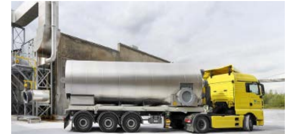
Lävemann, E. (2015). Mobile Sorptionsspeicher zur industriellen Abwärmenutzung - Grundlagen und Demonstrationsanlage - MobS II. Truck with thermo chemical TES trailer, ZAE Bayern, Germany
