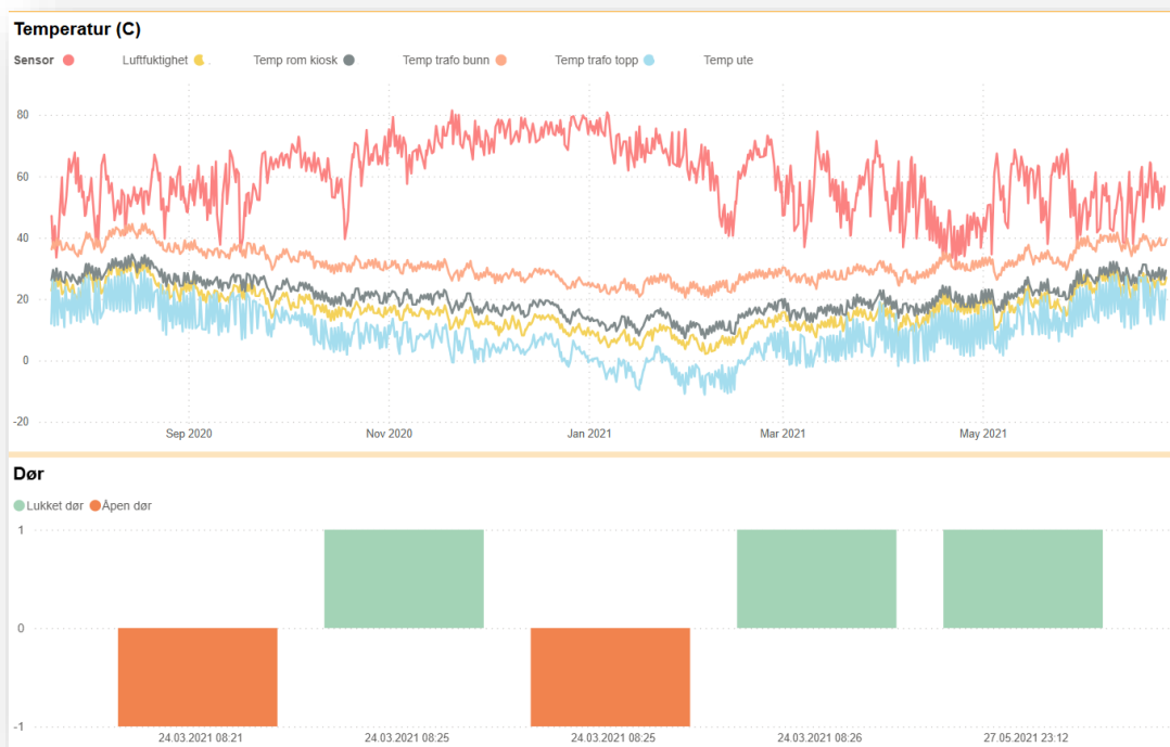
Figur 5 Skjerm bilde fra rapporten «Nettstasjonsinformasjon». Trafoen i nettstasjonen ble oppgradert i 2021. Før oppgradering var belastningen (øverste graf) på over 100% av merkeytelse i lengre perioder.
