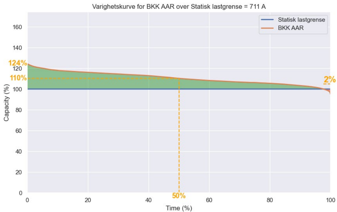
Figur 34: Varighetskurve for differansen mellom dagens AAR og den statiske lastgrensen på 711 A
