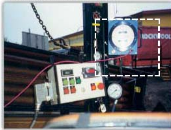
Klokke montert i borerigg
