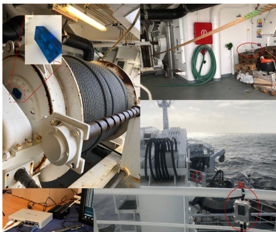
M/S «Eros»: Blåtannenheter på vinsjer; Forlengelsesenheter for trådløs forbindelse (innringet).
